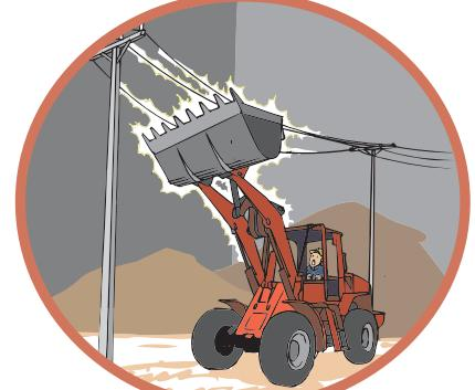
En caso de contacto eléctrico, no salgas de la máquina hasta estar en condiciones de seguridad
