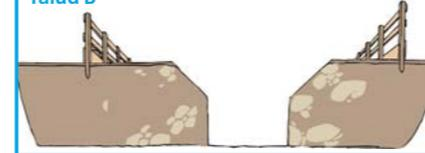
Las zanjas deben entibarse a partir de una profundidad de 1,5 m.
