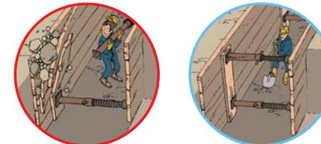
Las zanjas se atravesarán mediante pasarelas con barandillas.
